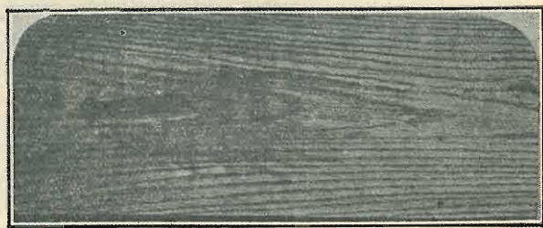
Fig. 6. — Tavola di quercia esposta a inumidirsi e seccarsi alternativamente: la sola parte centrale aveva perduto lo strato di vernice.
